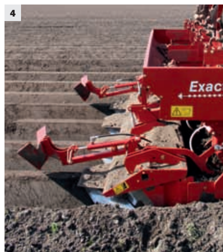
De hoeveelheid in het element (3) wordt via sensoren zeer nauwkeurig gestuurd. Na de afleg van de knollen wordt de rug meteen met de aanaardkap (4) gevormd.
